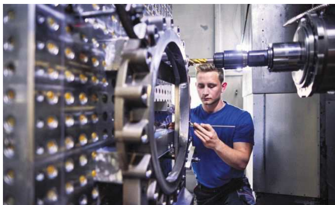
Ein Sistag-Mitarbeiter kontrolliert die Zerspannungsbearbeitung eines Plattenschiebergehäuses.
